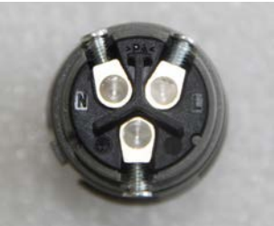
▲ Figura 4.13: Interno del connettore del terminale di rete CA
