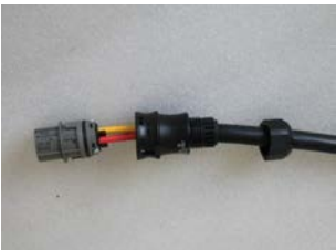
▲ Figura 4.16: Collegamento dei fili al terminale
