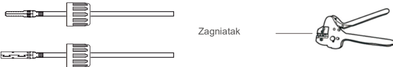
▲ Rysunek 4.10 Zaciśnięcie styku kontaktowego na przewodzie
