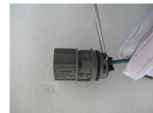
▲ Rysunek 4.16 Podłączenie przewodów do zacisku
