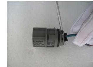
Figure 4.16 Connecter les fils à la borne
