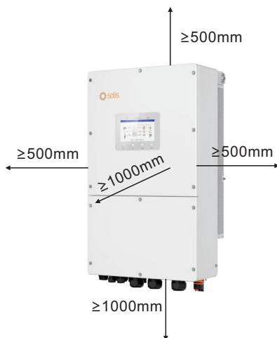
图 3.5 逆变器安装间隙
