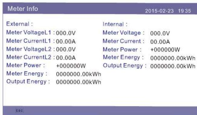
Figura 5.10 Información del medidor
