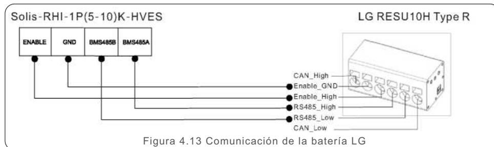
Figura 4.13 Comunicación de la batería LG
