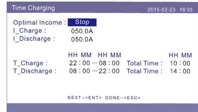
Figura 5.38 Carga por horas
