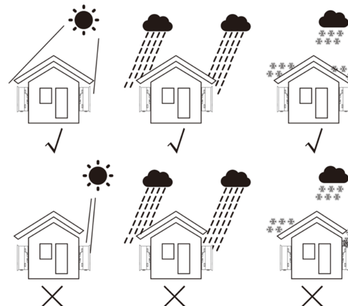
▲ Figure 4.1 Position d'installation recommandée
