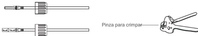
▲ Figura 5.14 Crimpe la clavija de contacto al cable
