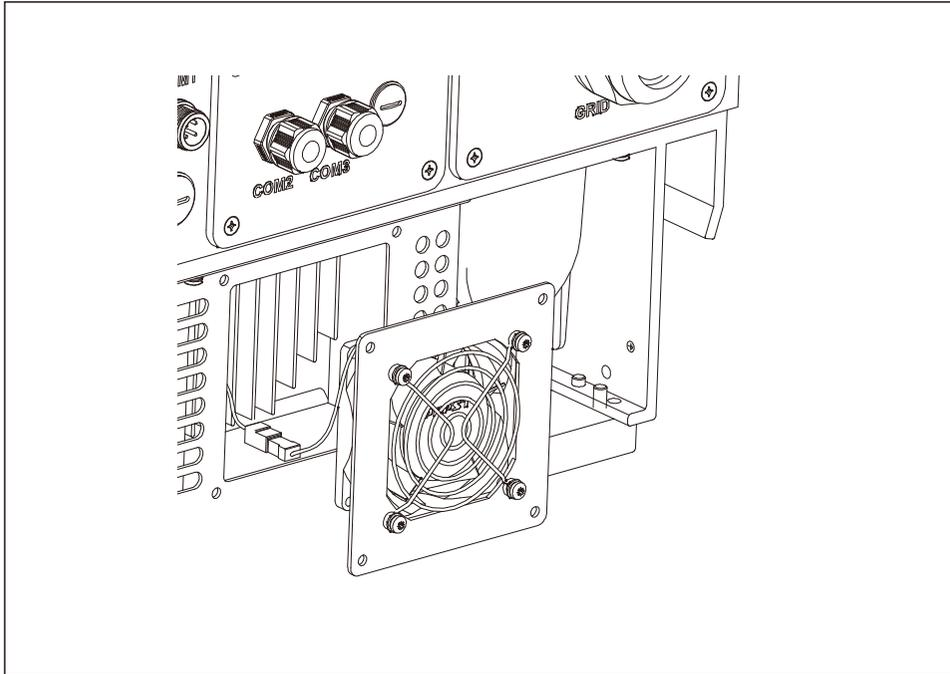
5. Desconecte el conector del ventilador con cuidado y saque el ventilador.
