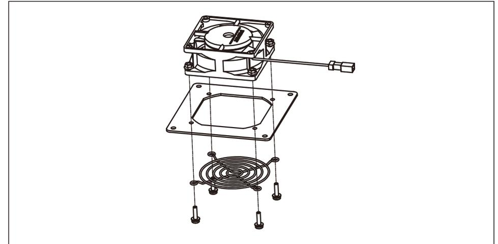
7. Conecte el cable eléctrico y vuelva a instalar el conjunto del ventilador. Reinicie el inversor.
