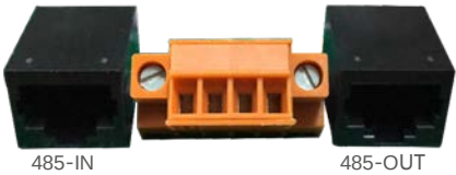
▲ Hình 5.24 Cổng RJ45 và bảng đầu nối
