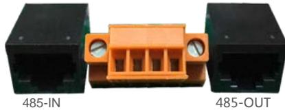
▲ Abbildung 5.24 RJ45-Anschluss und Klemmenleiste
