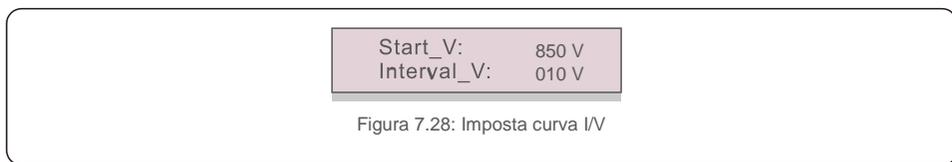
Start\_V: la tensione di avvio della scansione I/V. (Regolabile da 850 V a 1000 V)
