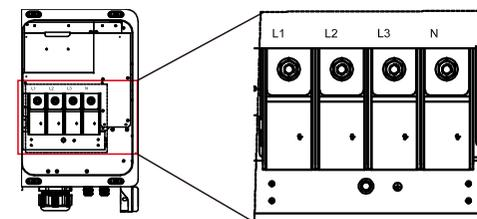
Figura 3.27 cablaggio con Neutro (Solis-(75-80)K-5G)
