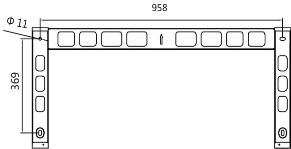
Figura 3.5 Montaggio a parete dell'inverter
