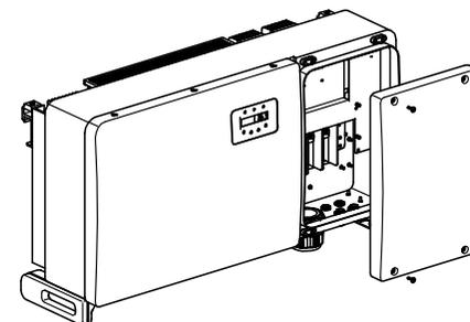
Figura 3.26 Rimuovere il coperchio della scatola di giunzione
