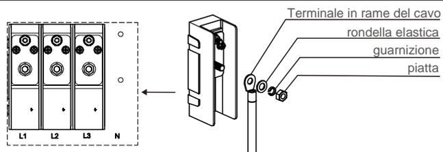
Figura 3.25 Terminale di trasferimento in rame e alluminio
