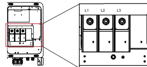
Figura 3.28 cablaggio senza neutro (Solis-100K-HV-5G, Solis-110K-BHV-5G)
