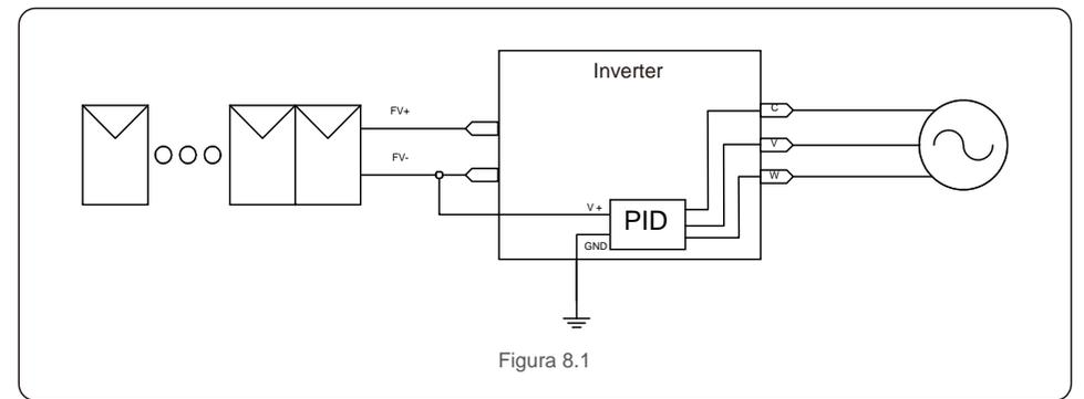
Il modulo Anti-PID ripara l'effetto PID del modello FV di notte. Durante il funzionamento, lo schermo LCD dell'inverter visualizza le informazioni di "riparazione PID" e la luce rossa è accesa. La funzione Anti-PID è sempre attiva quando viene applicata la CA.
