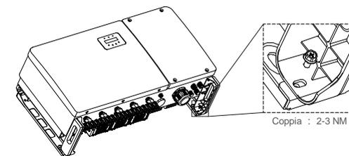
Figura 3.8 Fissare l'inverter
