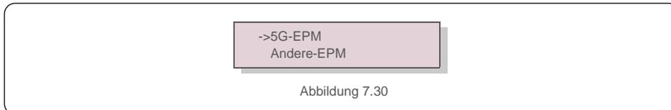
5G-EPM-Ausfallsicherheits-Option sollte aktiviert werden, wenn ein EPM-Gerät der 5G-Serie verwendet wird. Die Andere-EPM-Ausfallsicherheits-Option sollte aktiviert werden, wenn ein EPM-Gerät der 2G-Serie verwendet wird. Es kann jeweils nur eine Option aktiviert werden.
