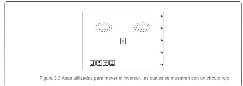
Figura 3.3 Asas utilizadas para mover el inversor, las cuales se muestran con un círculo rojo
