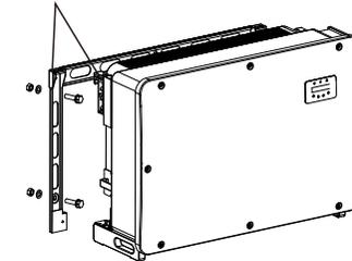
Figura 3.6 Instalar el inversor
