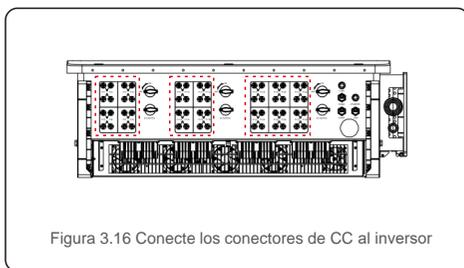
Figura 3.16 Conecte los conectores de CC al inversor
