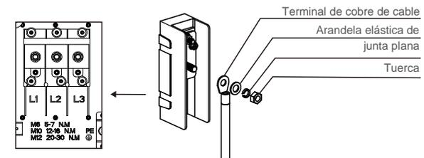
Figura 3.18 Terminal de transferencia de aluminio y cobre
