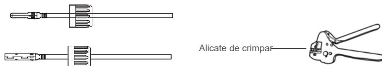
▲ Figura 5.14 Crimpe o pino de contacto no fio
