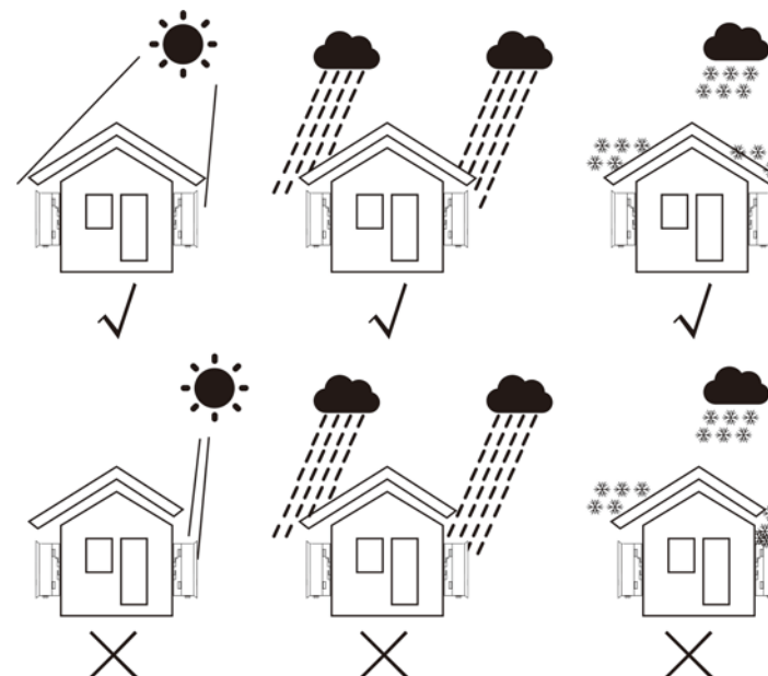
▲ Figure 4.1 Position d'installation recommandée
