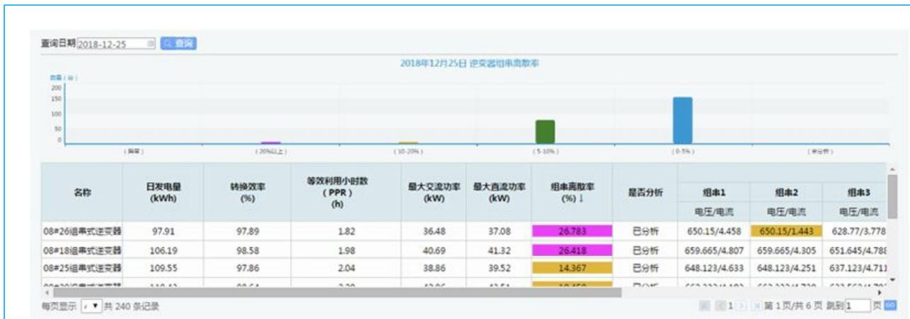
根据下列数据区间经验判断，对于**支路电流为0的组串和明显电流偏低的组串**现场实地排查。
