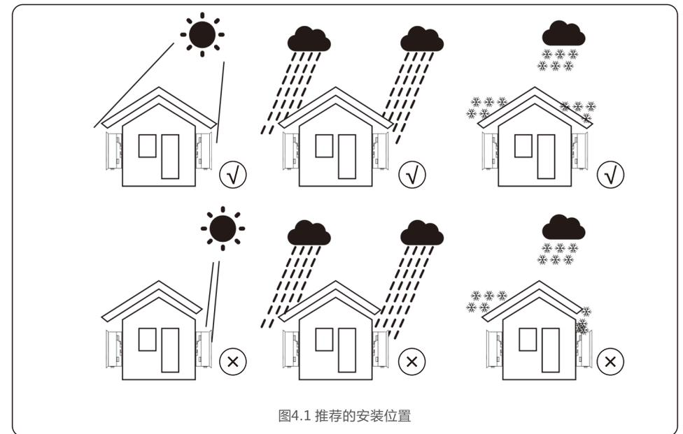
图4.1 推荐的安装位置
