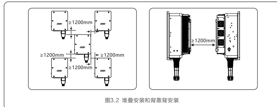
图3.2 堆叠安装和背靠背安装
