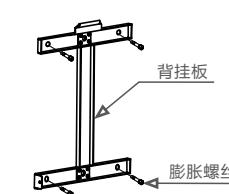
图3.6 逆变器墙壁安装
