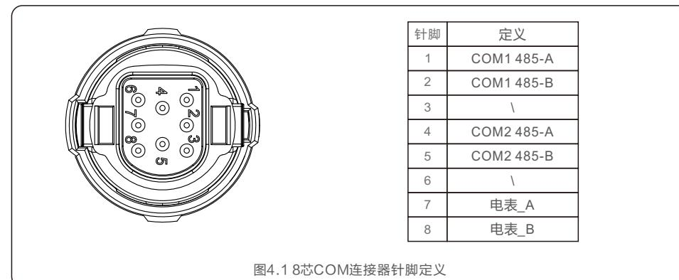
图4.1 8芯COM连接器针脚定义
