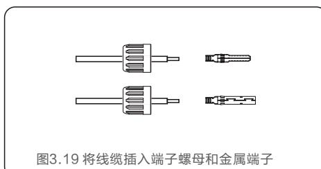
图3.19 将线缆插入端子螺母和金属端子
