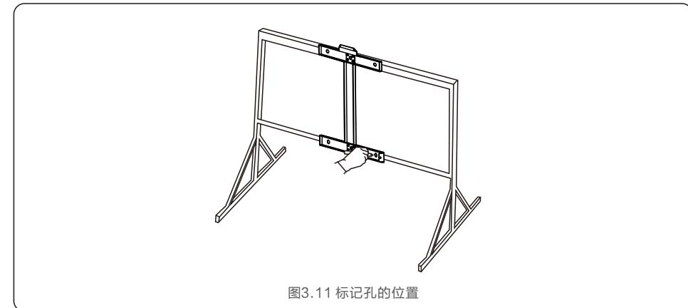
2. 钻出标记的孔。建议在孔处涂防腐蚀涂料以防腐蚀。
