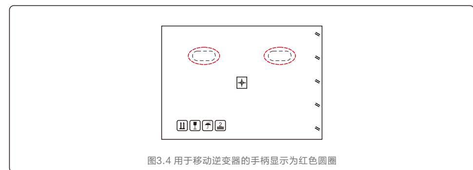
图3.4 用于移动逆变器的手柄显示为红色圆圈
