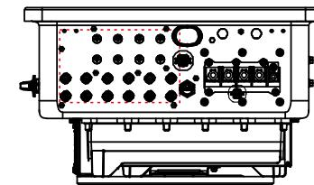
图3.23 将直流连接器连接到逆变器
