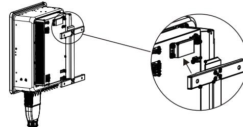
图3.7 安装逆变器
