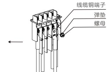
图3.27 铜铝过渡转接端子
