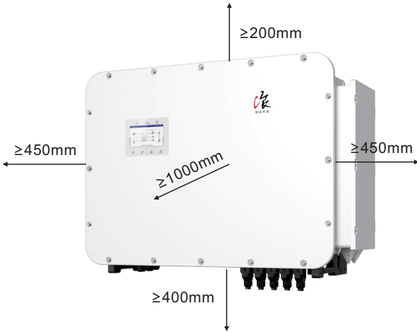
图3.3逆变器安装间隙
