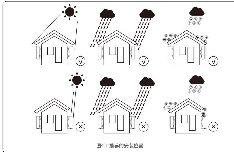
图4.1 推荐的安装位置
