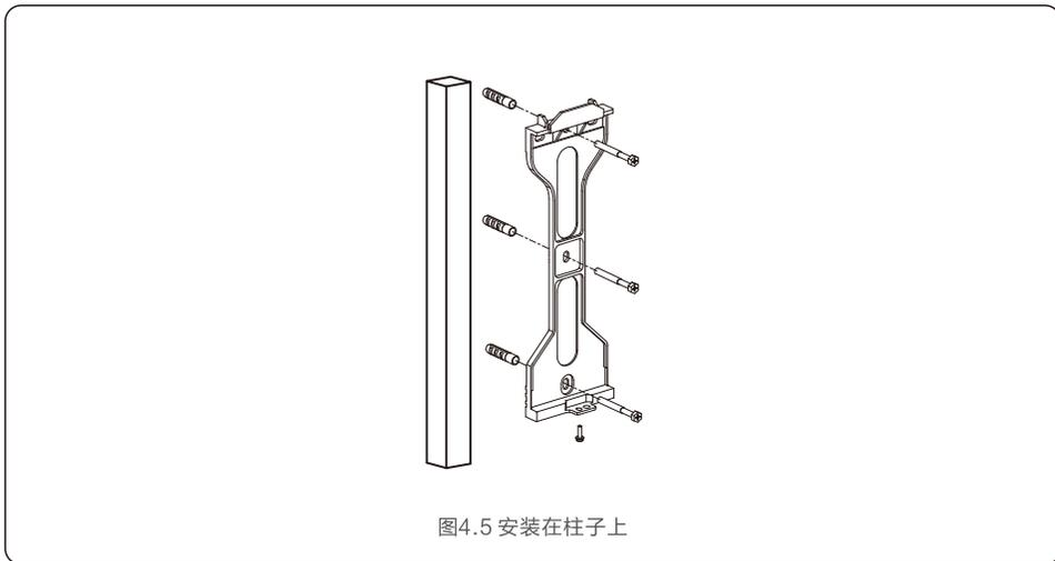
图4.5 安装在柱子上
