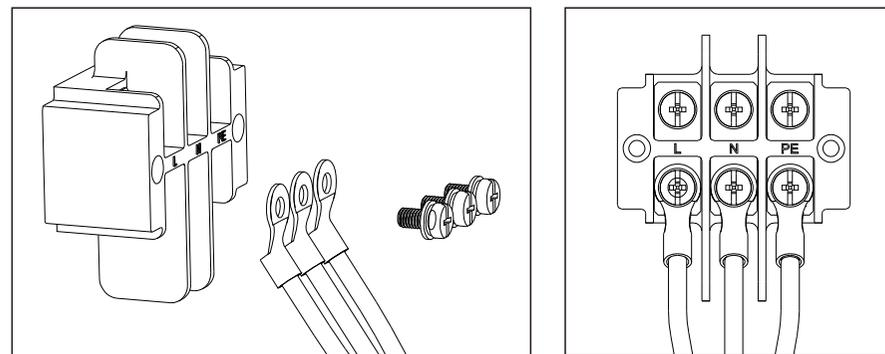
图4.16 铜铝过渡转接端子
