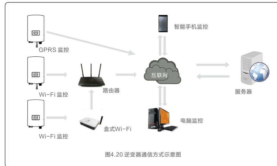
图4.20 逆变器通信方式示意图
